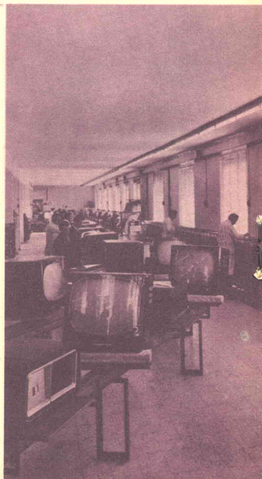
(In basso): Cabine di collaudo poste al capolinea del percorso di montaggio dove convergono le due linee: è il punto di partenza della fabbricazione.
